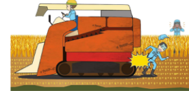
《災害事例》 収穫の位置変えのためコンバインを後退したところ、補助者に激しく当たる
