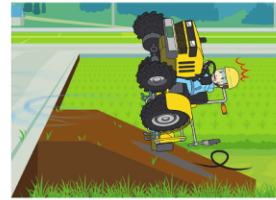
《災害事例》 ほ場から公道への坂道でスピードを出しすぎて横転する
